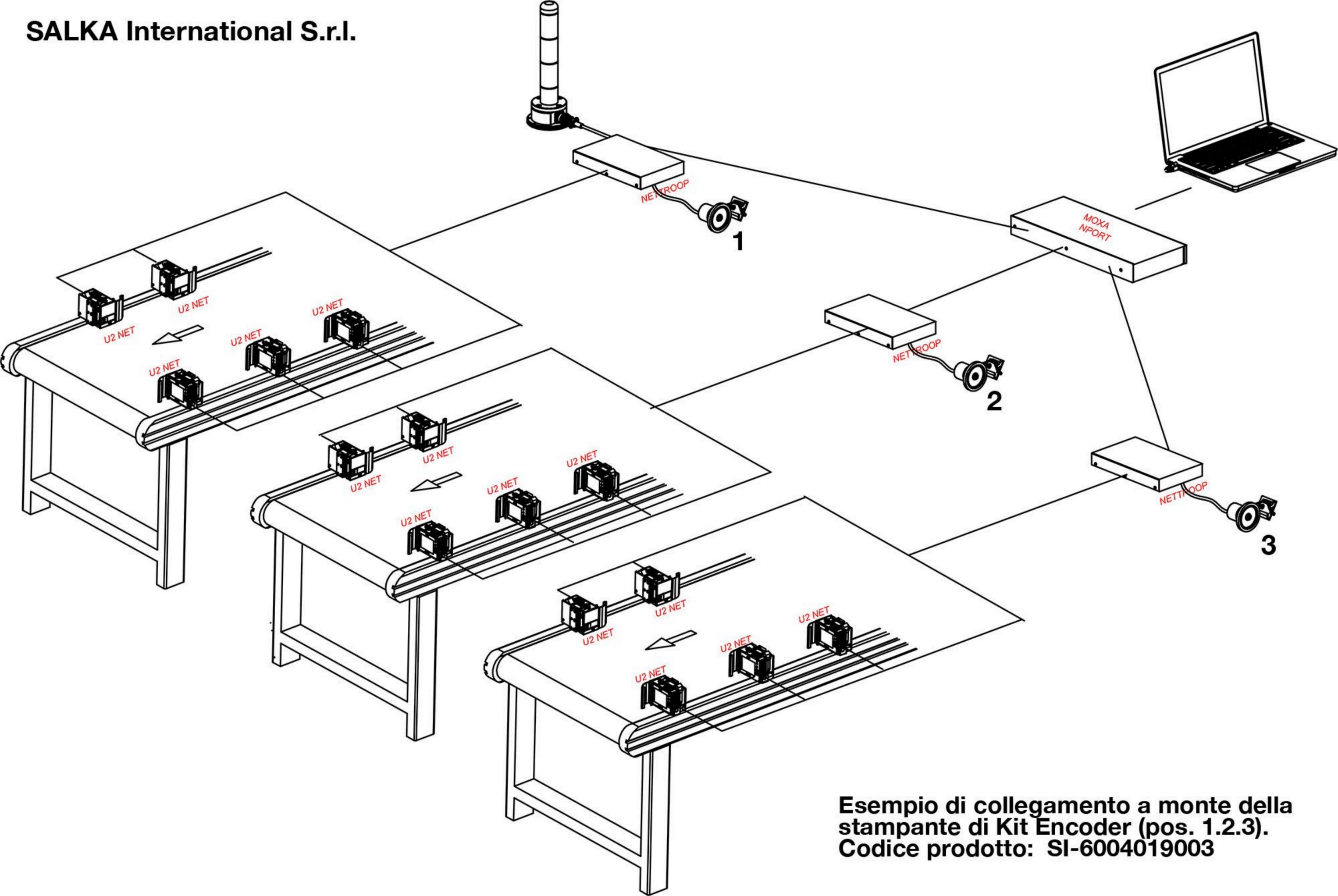
**Esempio di collegamento a monte della stampante di Kit Encoder (pos. 1.2.3).
